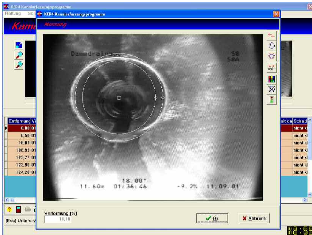
Abbildung 15 Verformungsmessung im Kanaldatenerfassungsprogramm KEP 5.0
